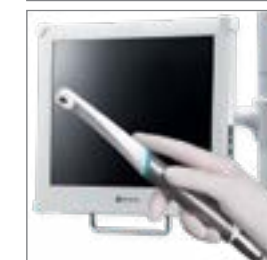
KAMERA WEWNĄTRZYSTNA MYRAY C-U2 - jakość HD (720p), stopklatka, podział ekranu na 4 części
